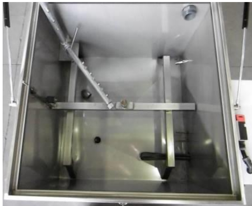
Vista interior del tanque de lavado con la entrada de la bomba, la resistencia y la sonda de nivel mínimo
