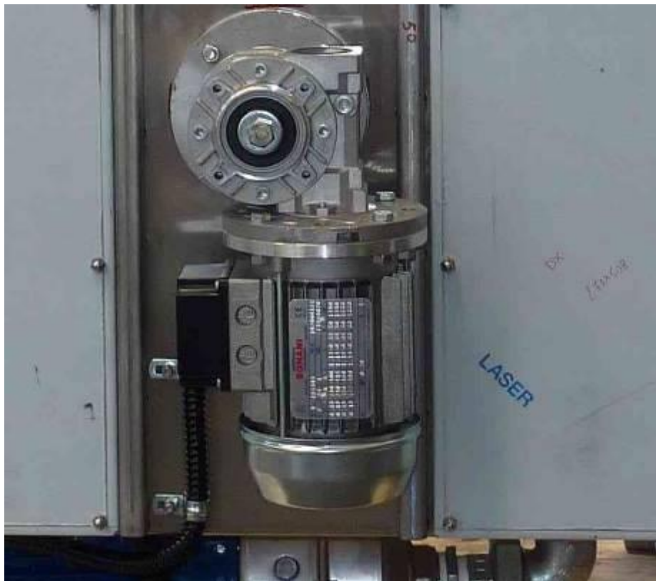
Rotación motorizada de la cesta mediante motor-reductor
