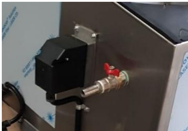
Motor y válvula de descarga del separador de aceite de disco
