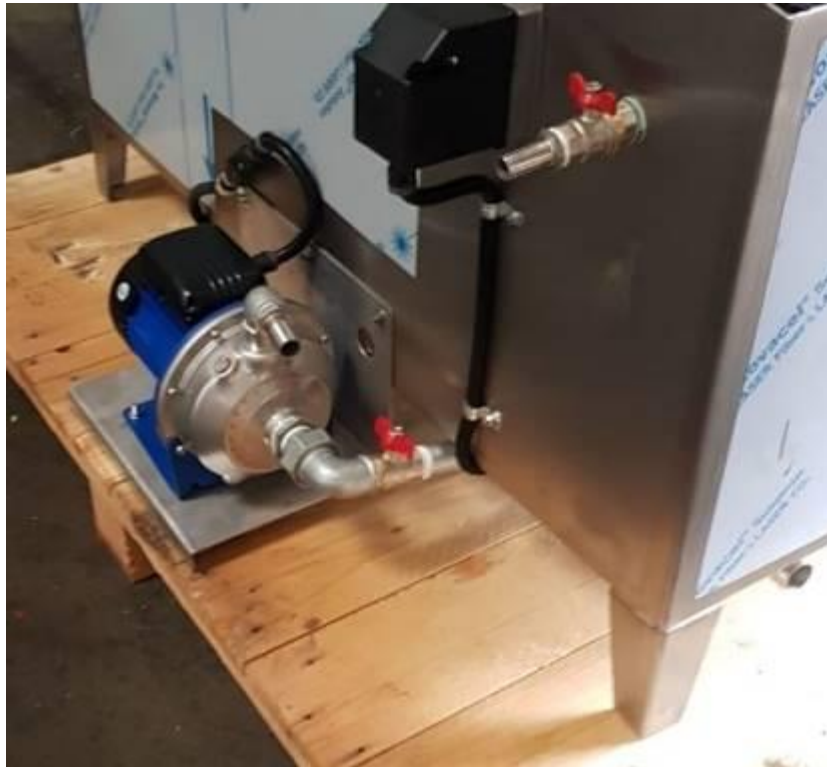
Descarga automática del agua del tanque mediante una bomba accionada con un pulsador desde el cuadro eléctrico
